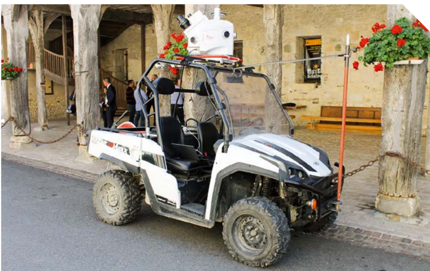
Véhicule équipé d'un scanner embarqué
