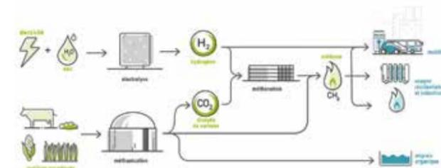
L'installation a pour objectif de démontrer la faisabilité technique et économique du procédé de Power-to-gas (utilisation de l'électricité issue de ressources renouvelables) pour obtenir du gaz vert et ainsi répondre à l'un des défis de la transition énergétique : stocker l'énergie demain.
