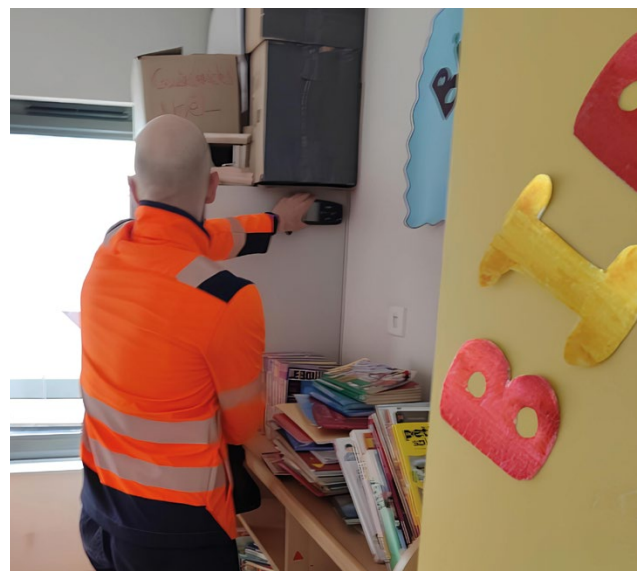
Pose d'un enregistreur de température dans les locaux
