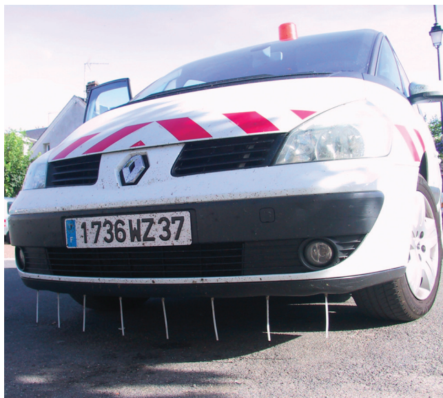
Véhicule de Surveillance et de Recherche (VSR) de fuites sur les réseaux.
