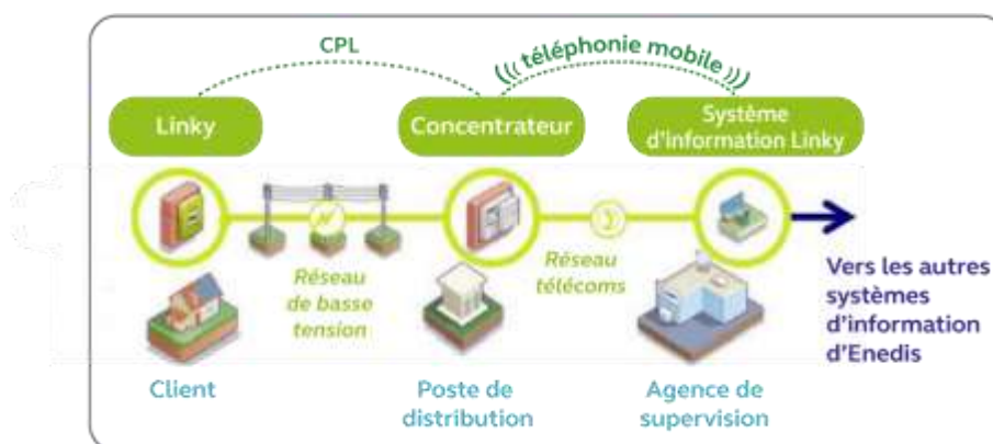
Schéma n° 3 : architecture de Linky
