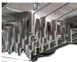
**GESTION THERMIQUE:** Système de refroidissement interne pour dissiper la chaleur des LED en forme d'alvéole, sans ailettes
