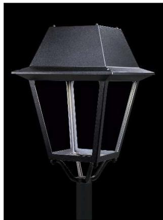
Luminaire Simon PRAGA modèle M PRO, fixation post-top 3/4" G, surface plane et diffuseur en verre trempé transparent plat. Classe II, IP66.
