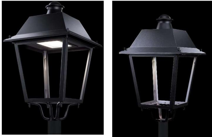
Luminaire Simon PRAGA, modèle basique à injection d'aluminium. Modèle M, fixation post-top 3/4" G, surface plane, diffuseur en méthacrylate très résistant aux chocs, transparent et plat. Classe II, IP66. Tension d'alimentation 230 V, 50/60 Hz. Bloc optique Istanium® LED multi-array avec optique RJ routière frontale J d'une portée maximale de 68,8°, dispersion maximale 54°, lumière du jour neutre. Bloc optique protégé par un diffuseur transparent plat, entretien facile et pertes minimales.
