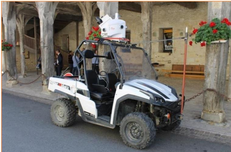
Scanner embarqué sur un véhicule
